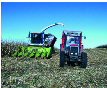
Høst af kolbemajs med en finsnitter med plukkebord.
