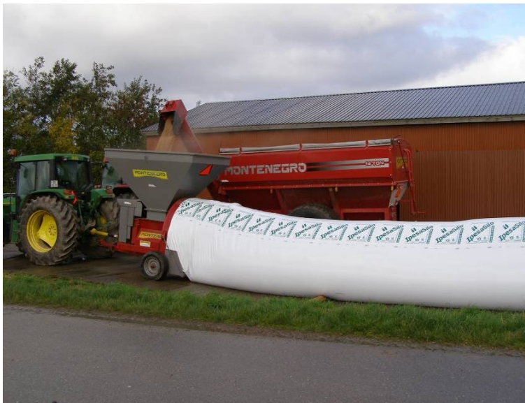
Figur 1. Fyldning af silopose med sneglevogn. Foto Jens J. Høy, AgroTech.
