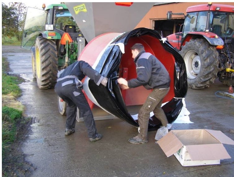
Figur 2. Posen placeres på "pølsehornet". Foto Jens J. Høy, AgroTech.
