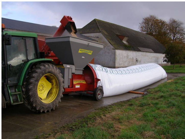
Figur 5. Der blev lagt et plastrør under posen, så der ikke kunne samles regnvand på den ene side af posen. Foto Jens J. Høy, AgroTech.
