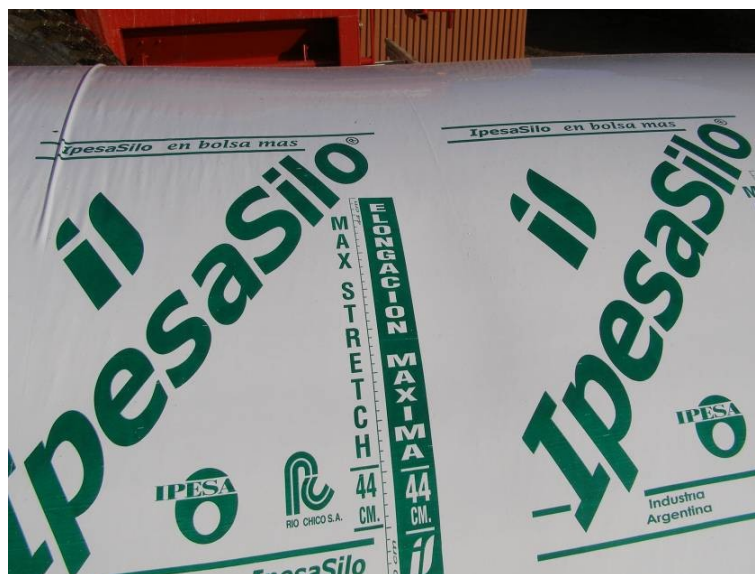
Figur 3. "Strækmærker" på posen til at sikre en passende fyldning. Foto Jens J. Høy, AgroTech.
