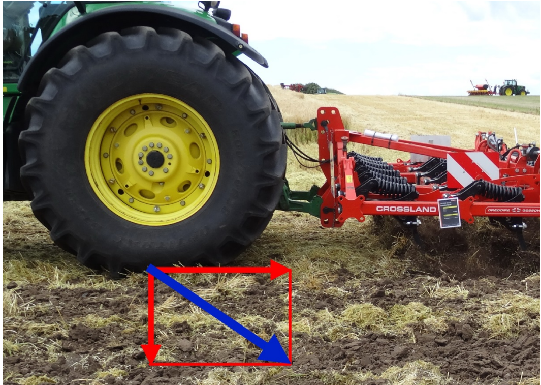
Billede 2. Overførsel af kræfter fra et trækkende hjul, til jorden – såvel vertikale som horisontale kræfter (de røde linier). Den blå linie viser summen af kræfterne.
