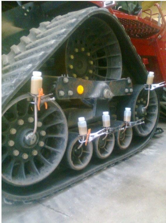
Billede 8. Påfyldning af olie på bærerullerne.
