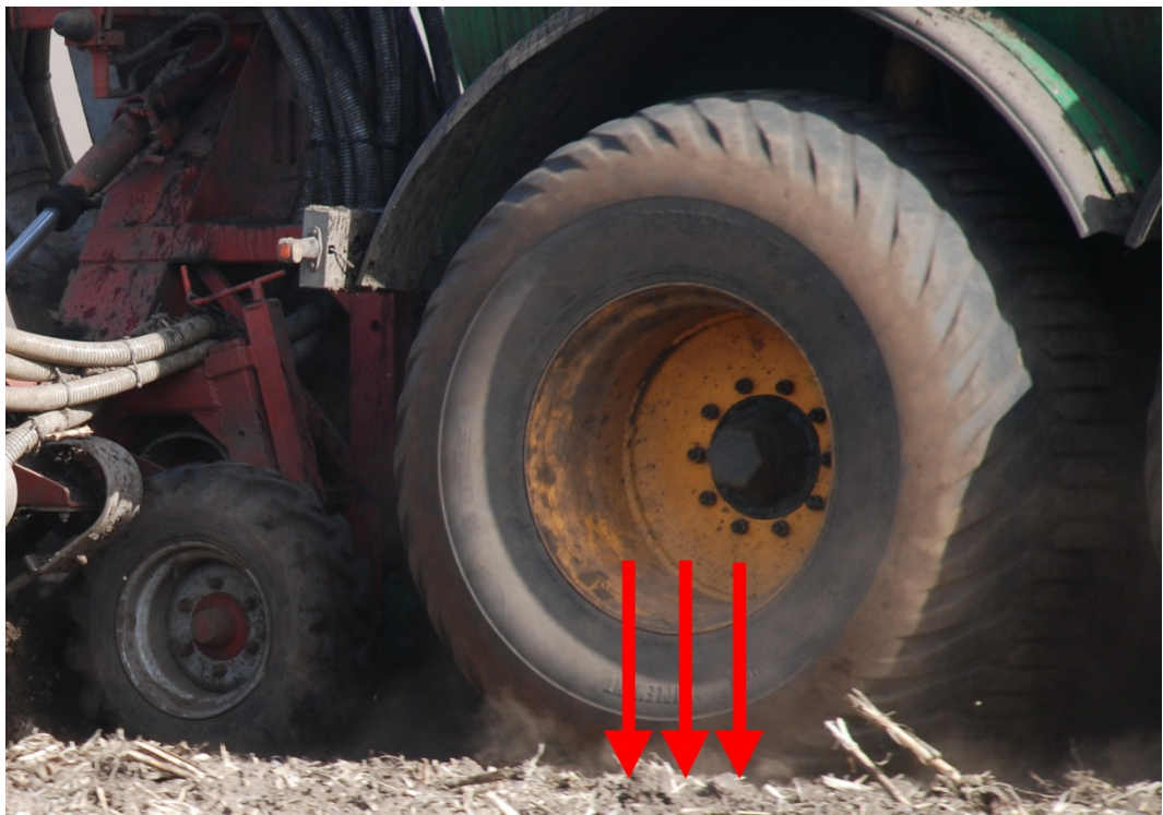
Billede 1. Overførsel af kræfter fra et hjul til jorden via et "ikke trækkende hjul". Dvs. der alene er tale om overførsel af vertikale (lodrette) kræfter.
