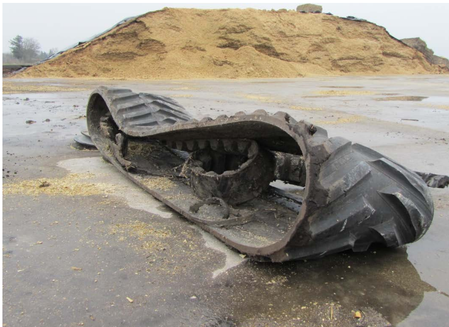
Billede 5. Ødelagt bælte.
