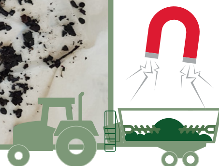
Metal tilbageholdt i en JF-Stoll VM-45 fuldfoderblender monteret med to topmagneter fra Grønning Smede- og Maskinforretning. Foto: SEGES
