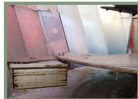
Top- og knivplademagnet udviklet af Grønning Smede- og Maskinforretning til Kongskilde/JF-Stoll-fuldfoderblandere. Foto: SEGES
