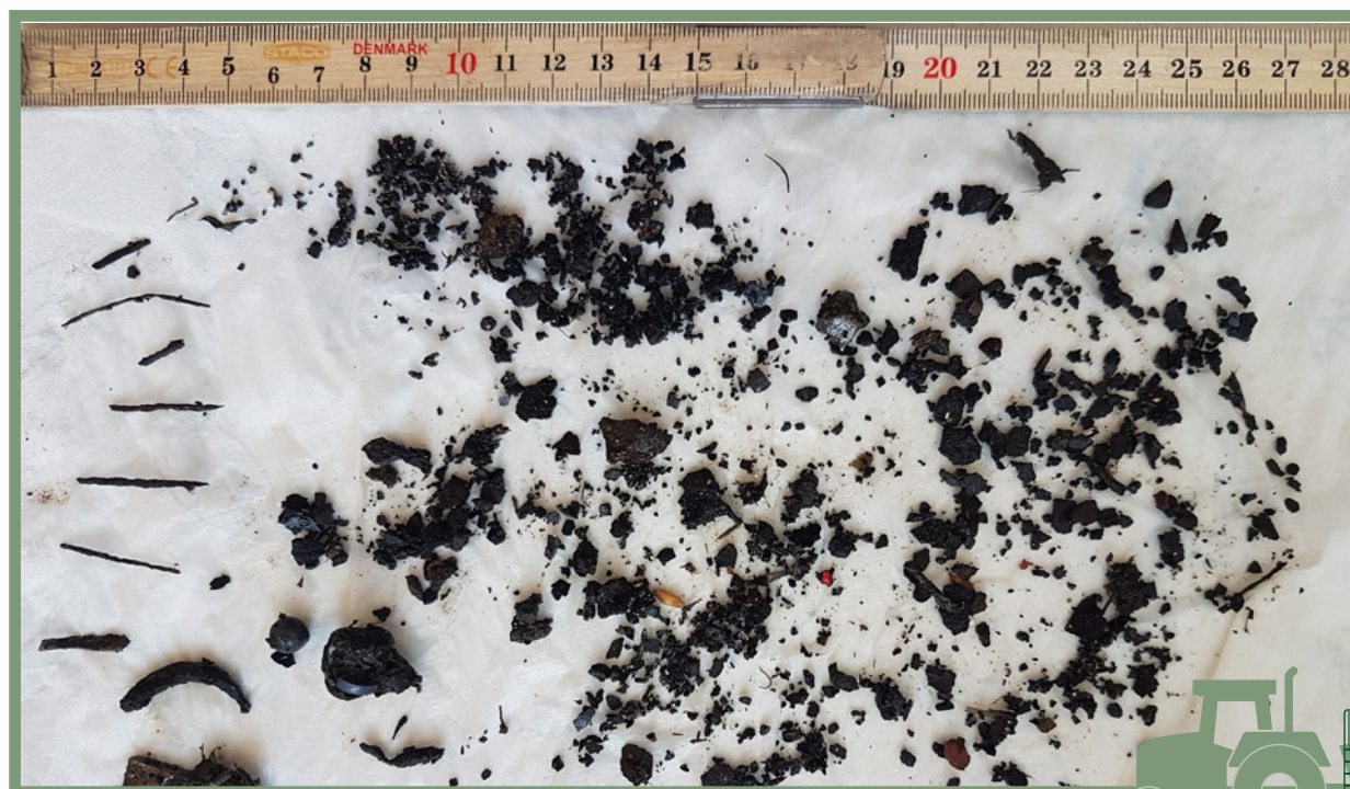
Metal tilbageholdt i en JF-Stoll VM-45 fuldfoderblender monteret med to topmagneter fra Grønning Smede- og Maskinforretning. Foto: SEGES
