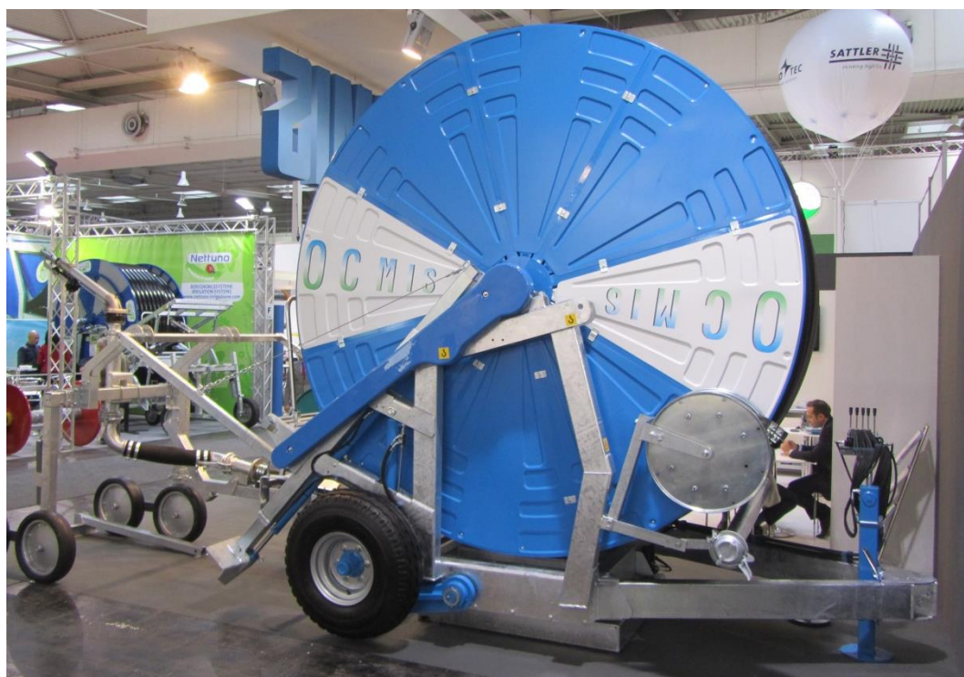
Indtræksmaskiner er opbygget sådan, at slangetromlen og drivværket bliver stående på forageren, mens kanonvogn og slange trækkes ud på marken. Når slangen er trukket helt, og maskinen sættes i gang, sørger tromlen for at trække kanonvogn og slange ind igen, alt imens maskinen vander. Foto: H.S. Lyngvig
