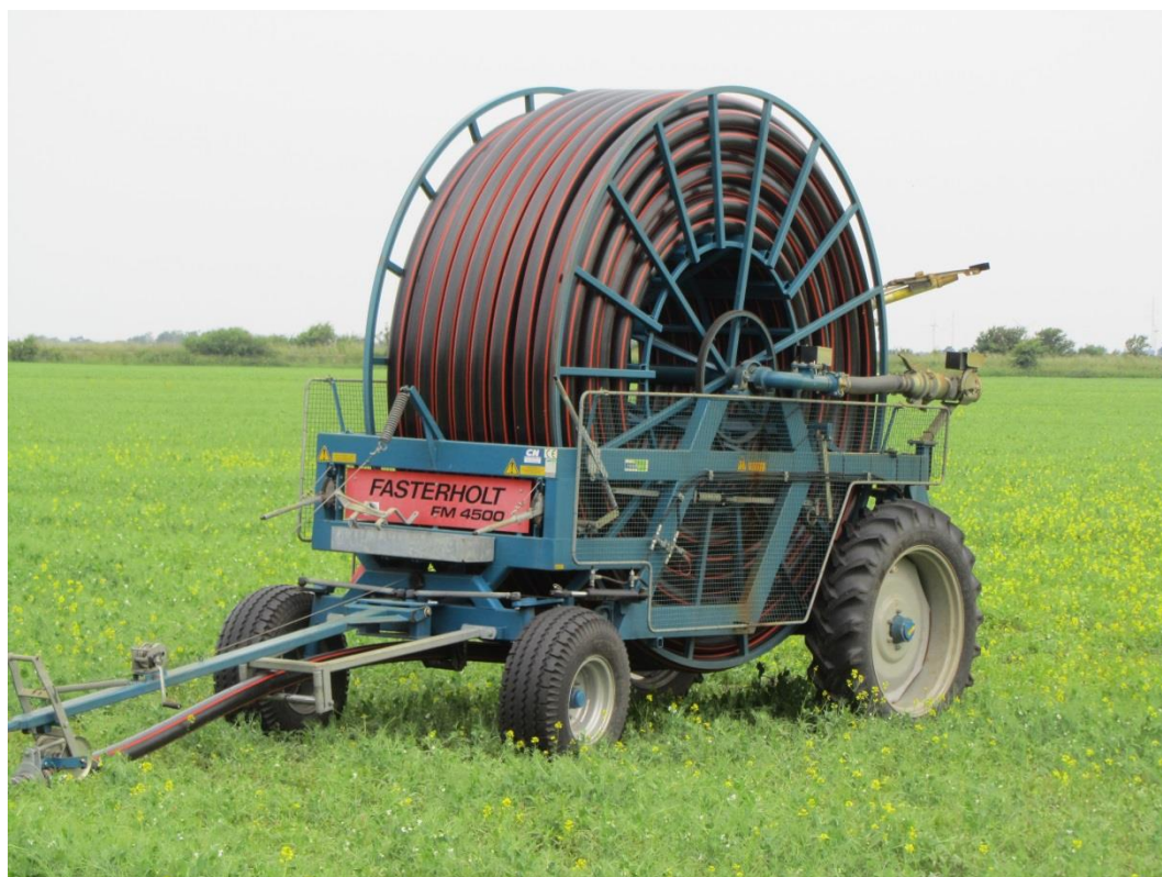
Selvkørende maskiner kører hen over marken og ruller slangen op på slangetromlen, imens den kører tilbage mod startpunktet. Vandingskanonen er monteret på vandingsmaskinen. Fordelen ved denne maskintype er, at den er hurtig og enkel at flytte til en ny opstilling, og at slangen kan lægges i bløde buer. Eksempelvis hvis slangen er noget længere end den mark, der aktuelt vandes på. Foto: Henning Sjørsløv Lyngvig
