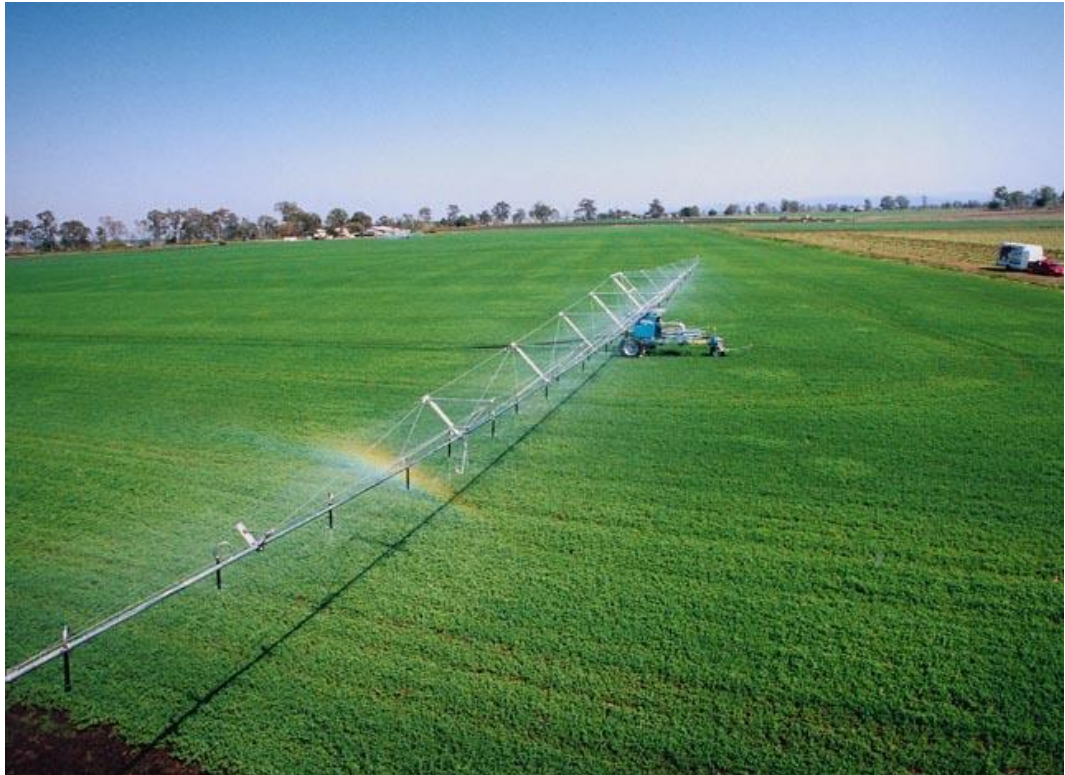
Billede 2. Bomvanding giver lille vindfølsomhed, men en relativt høj vandingsintensitet. Foto: Rodney Industries.
