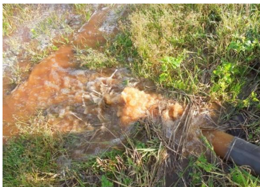
Billede 8. Okkerfyldt vand fra prøvepumpning af boring.
