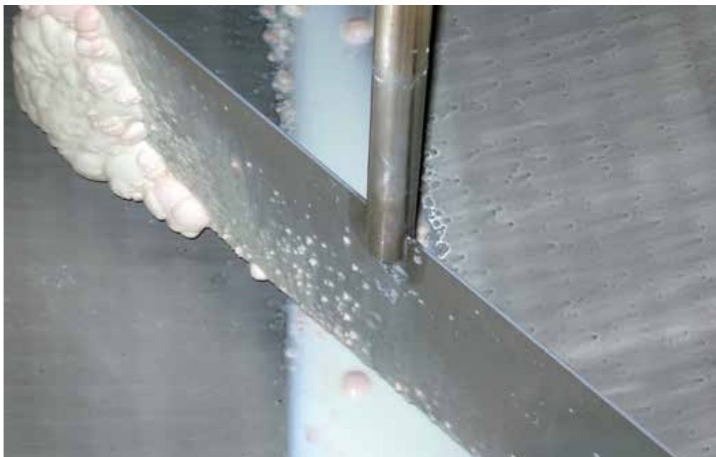
Fig 1. Kraftige belægnings på røreblad i mælkekøletank.
