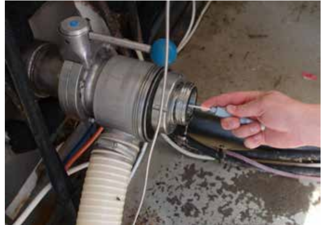
Fig 3. Udtagning af svaberprøver i tankstuds.
