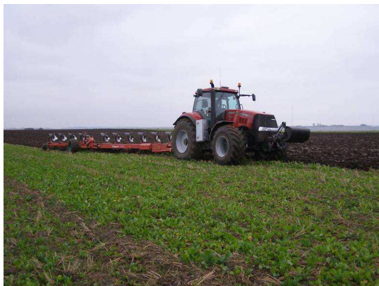
Figur 10. Pløjning med 10-furet plov. Foto: Jens J. Høy, AgroTech.
