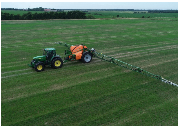
Billede 2. Den testede Amazone UX5200 Super med 36 meter bom
