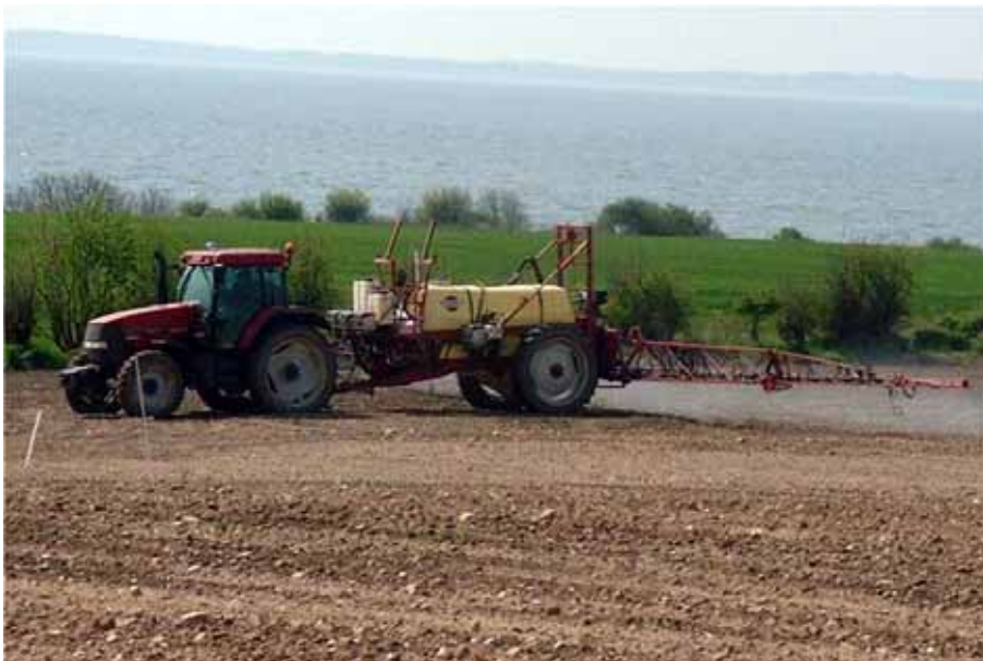
Figur 10. Forsøget blev udført med en 24 meter Hardi trailersprøjte. På sprøjten var monteret et Raven injektionssystem med fem doseringspumper.
