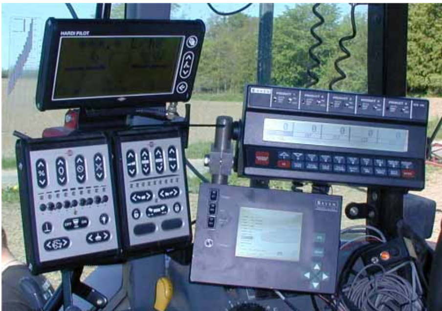
Figur 12. Computerne i traktorens cockpit. Raven SCS 750 (øverst til højre) kontrollerer doseringen fra de fem doseringspumper. Raven AMS (nederst til højre) er systemets datacomputer, der holder styr på doseringskort. Hardi Pilot (til venstre) styrer sprøjtens funktioner.
