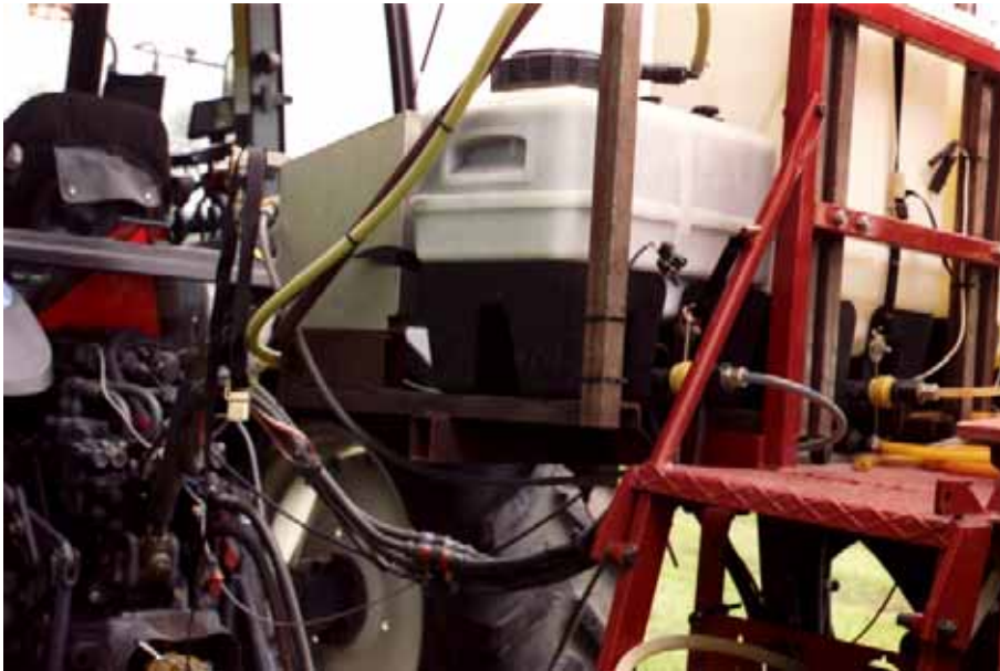
Figur 11. Hver doseringsenhed består af en beholder, der indeholder koncentreret sprøjtemiddel og en pumpe, der doserer midlet.
