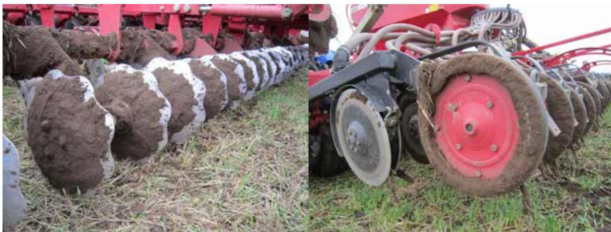
Billede 21. Bølgede tallerkenskær bearbejder jorden foran såskærene.
