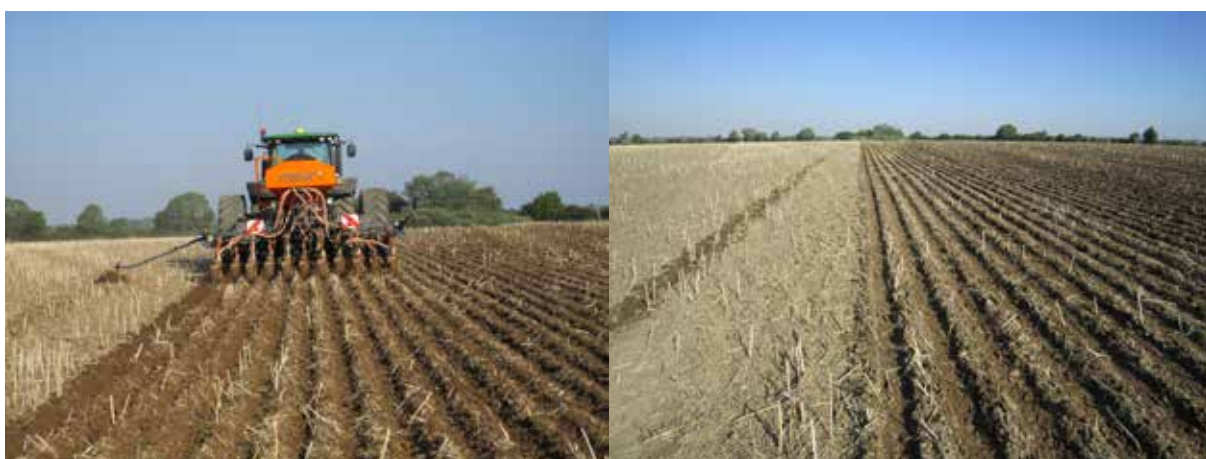
Billede 11. Mzuri Pro-Til 4T såmaskine. Bemærk de markerede kamme mellem såbåndene.
