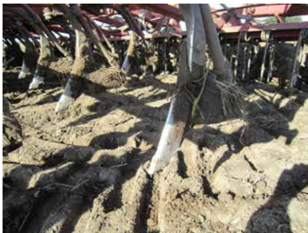
Billede 34. Tandsåskær på såmaskinen. Bemærk den lange og kraftige spids, som løsner jorden.
