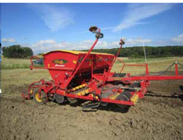
Billede 14. Bemærk det kraftige Crossboard Heavy Disc System, der bearbejder jorden foran enkeltskive-såskærene.
