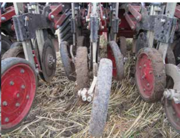
Billede 41. Dobbelte trykruller efter såskærene.
