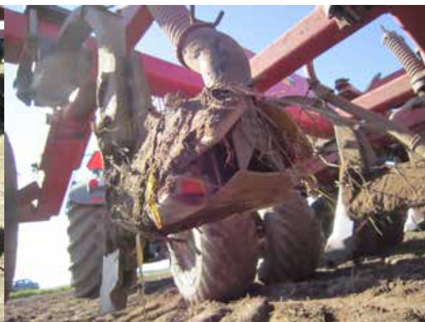
Billede 35. Bemærk det brede udløb fra såtuden. Såsæden bliver fordelt i et bånd. Bundpladen pakker jorden og skaber en fast bund, som kernerne lægges på.
