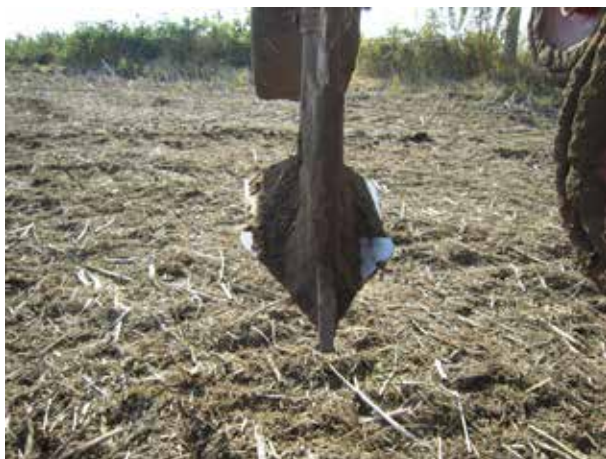
Billede 9. Såtand set forfra. Bemærk det brede såskær, som i kombination med en relativ høj hastighed ved såningen hypper jord op i kamme mellem såbåndene.
