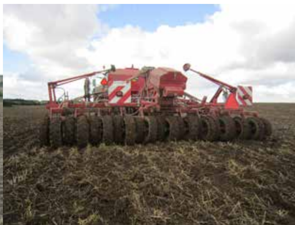
Billede 33. Offset dækpakker trykker jorden til efter såskærene.
