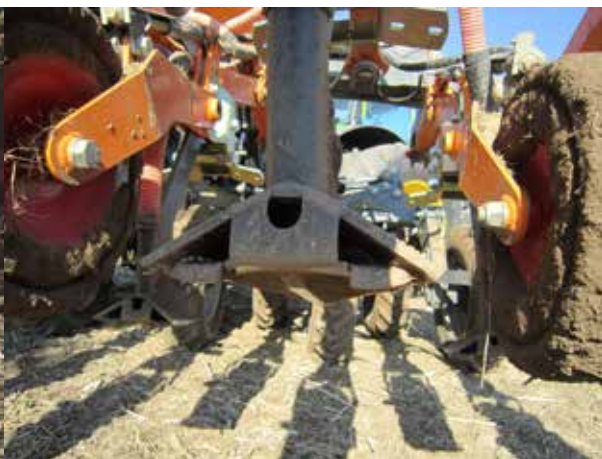
Billede 10. Såtand set bagfra. Bemærk de to udløb til såsæden.
