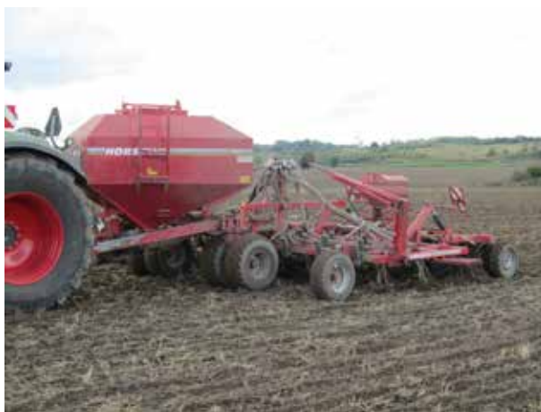
Billede 32. Horsch 6 CO tandskærs-såmaskine. Såningen foregik med 12-14 km/t.
