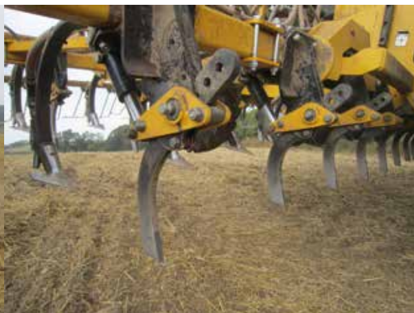
Billede 2. Grubbertænder og tandsåskær på Claydon Hybrid såmaskinen.
