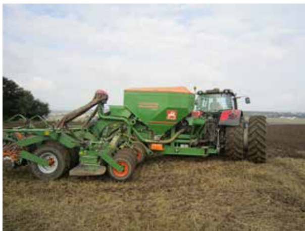
Billede 24. Amazone Cirrus 6000 Activ kombisåmaskine med rotorharve.
