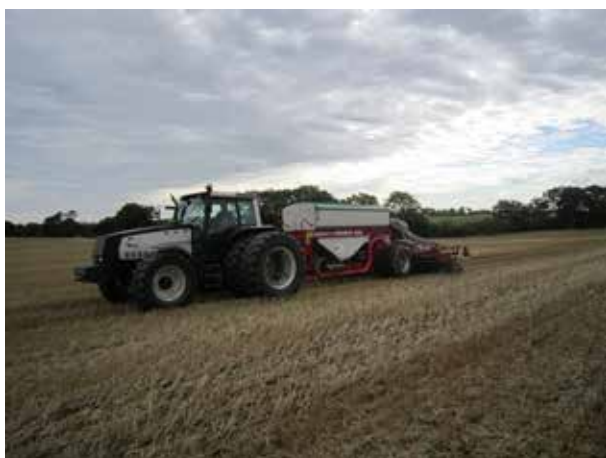
Billede 38. Weaving Big Disc såmaskine - sår direkte i stubben uden forudgående jordbearbejdning.
