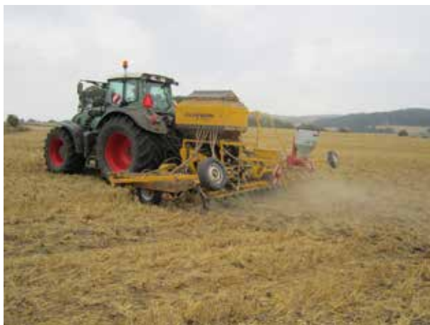
Billede 1. Seks meter Claydon Hybrid såmaskine ved såning af vinterhvede, der foregik med ca. 6 km/t.
