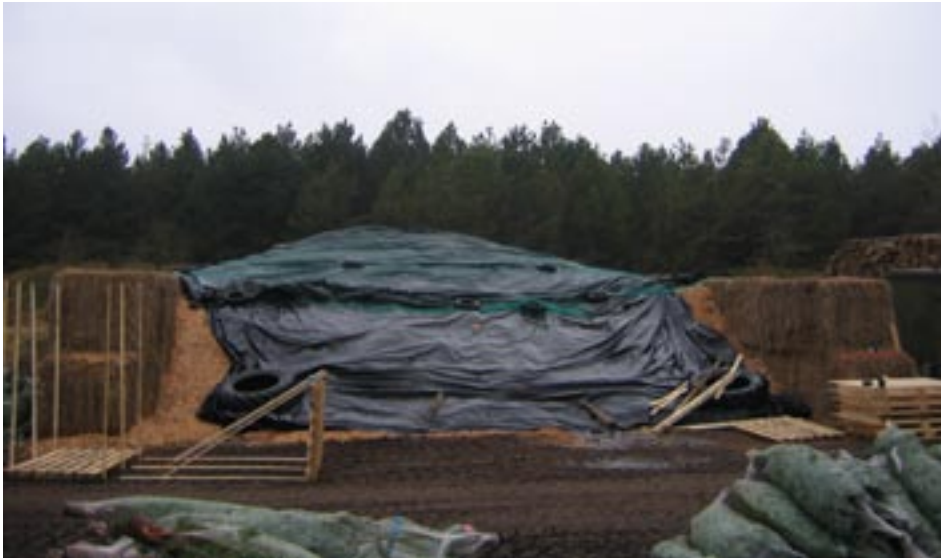
Figur 5.2. Sådaldt halmkumme med skovflis. Flisen er overdækket med plastdug, hvori der er lavet enkelte huller til ventilation. I alt ligger der ca. 600 rummeter flis i halmkummen.
