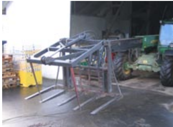
Figur 5.22. Klo på teleskoplæsseren – bruges til at håndtere pileskuddene med.
