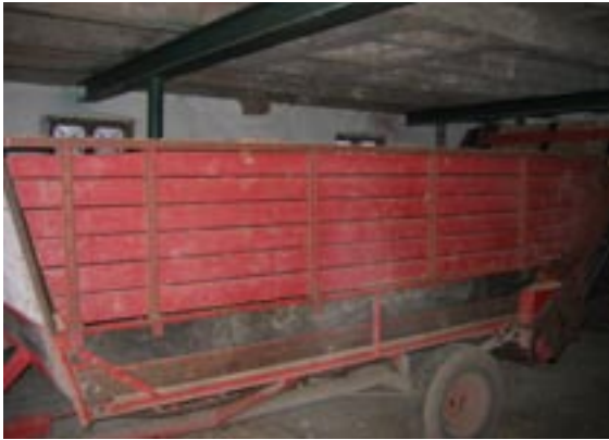
Figur 5.3. Aflæsservogn, der bruges til at flytte flisen fra halmkummen til flissiloen ved flisfyret.
