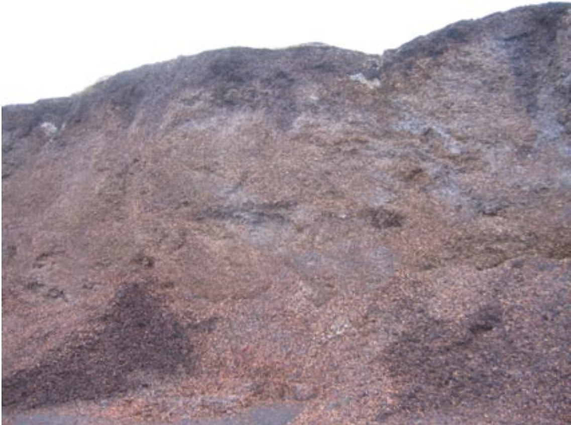
Figur 5.38. Flisen, der skal leveres til varmekværk, ligger udendørs. Bemærk de hvidskimlede områder med svampevækst.
