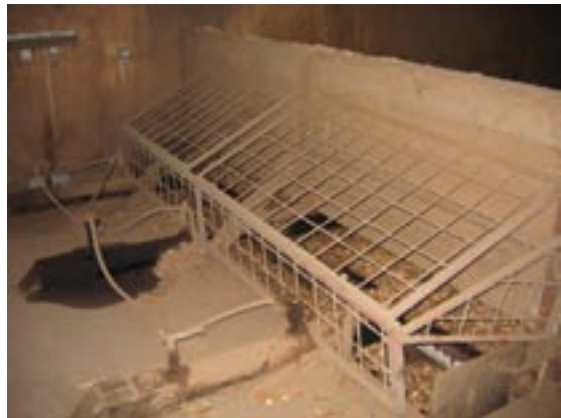
Figur 5.14. Stempler, som trækker flisen i siloen hen til sneglerenden.
