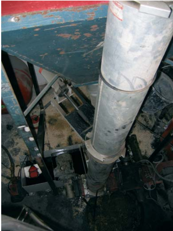
Figur 5.11. OK-røret leder det fransede materiale fra rysterenseren uden om oliepresseren og direkte ind i stokeren.
