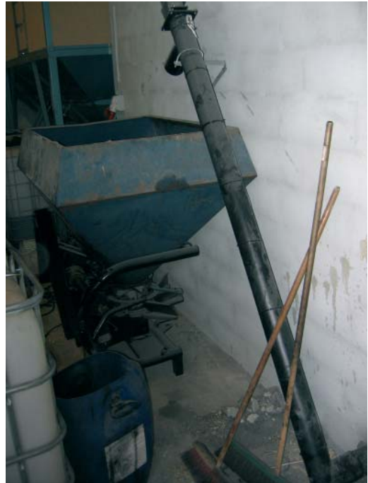
Figur 5.15 Den gamle gødningsspreder i baggrunden fungerer som midlertidig lagerbeholder for asken.
