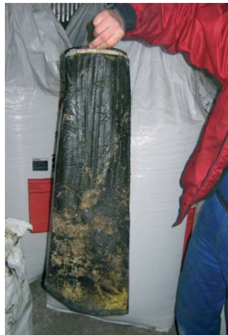
Figur 5.5. Brugt filterindsats (stofpose) fra filtermagen til det røde søjlefilter på figur 5.4. Bemærk, at slammet sidder udvendigt på posen - rapsolien presses udefra og ind gennem posen.
