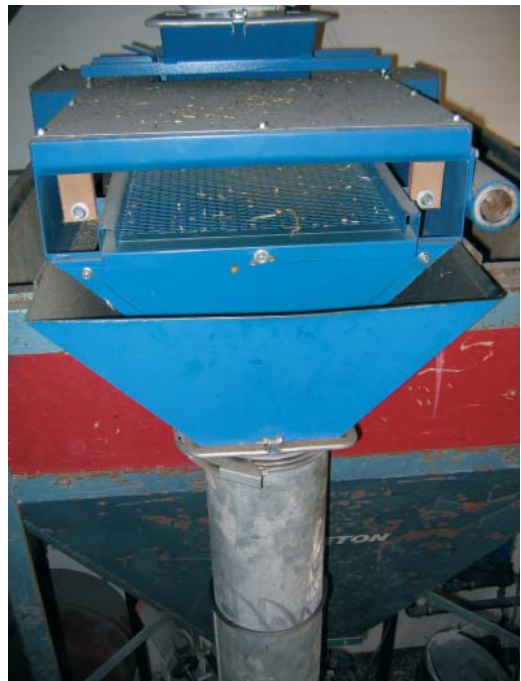
Figur 5.9. Det frarensede materiale ledes til tragtten og ned i OK-røret.
