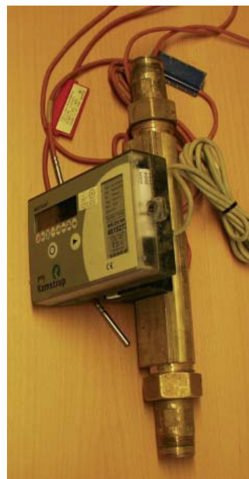
Figur 6.1. Kamstrup varmemåler, type 66C, nominelt flow på 6 \text{ m}^3 pr. time. Selve flowmålerdelen måler 260 \text{ mm} \times 5/4'' .
