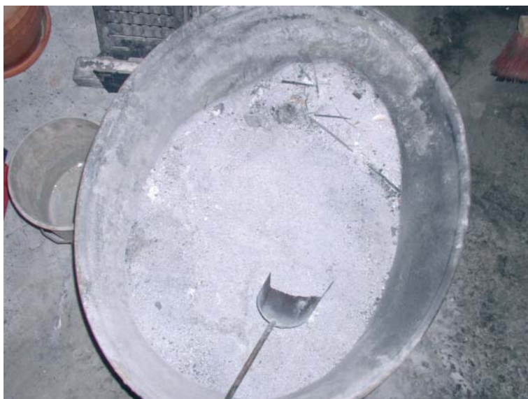
Figur 7.3. Aske fra det rapskagefyrede 20 kW bio-brændselsfyre. Asken er grå og pulveragtig, hvilket vidner om en god og tilfredsstillende forbrænding.
