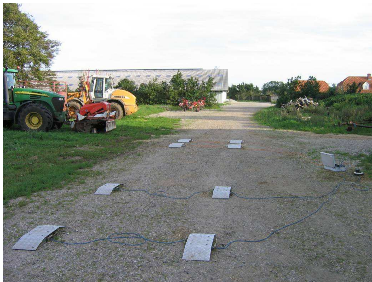
Figur 10. Læssene vejes på vejeceller, før græsset lægges ind på anlægget.
