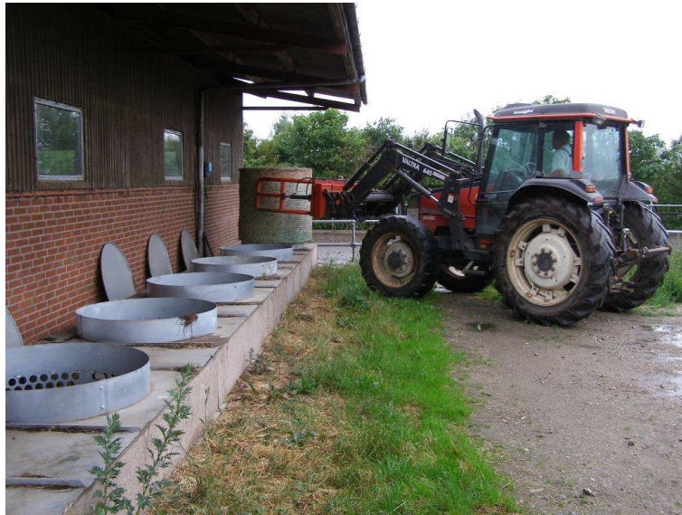
Figur 2. Der anvendes en frontlæssergrab, som kan drejes, så ballerne kan lægges på den flade side.
