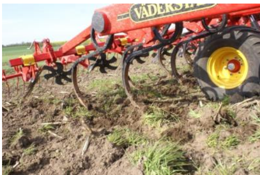
Figur 6.9: Fjedertænder kan typisk harve i 15-20 cm dybde. Foto: Henning Sjørsløv Lyngvig
