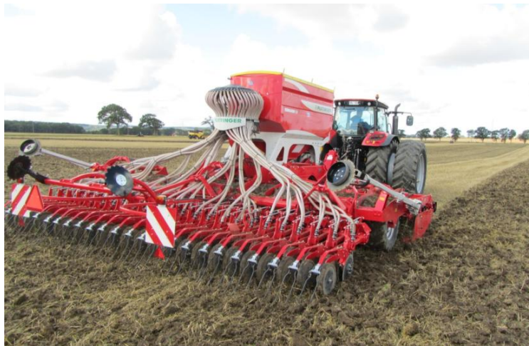
Figur 6.16: Såning med skiveskærssåmaskine hvor jordbearbejdning og såning foretages i én arbejdsgang. Foto: Henning Sjørsløv Lyngvig
