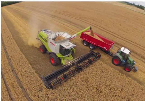
Figur 6.1: Der kan være udfordringer med spredningen af halmer ved store skærebordsbredder. Derfor er det vigtigt med korrekt indstilling af halmkniver og avnespreder, dette gælder uanset mærke. Foto: Stroco-Agro.
