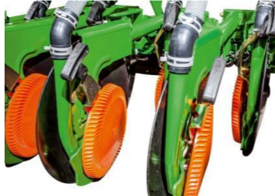
Figur 6.18: Skiveskær på Amazone Cirrus. Dybdestyringshjulet er monteret på siden af skiveskæret. Foto: Amazone
