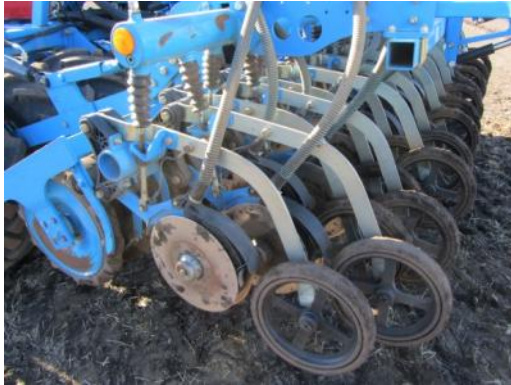
Figur 6.17: Skiveskær på Lemken Solitair. Dybdestyringshjulet er monteret efter skiveskæret. Foto: Henning Sjørsløv Lyngvig
