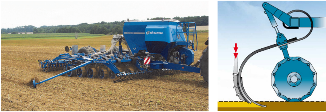
Figur 6.21 og Figur 6.22: Köckerling Ultima CS har et dybdestyringshjul foran hver såtand. Fotos: Köckerling
