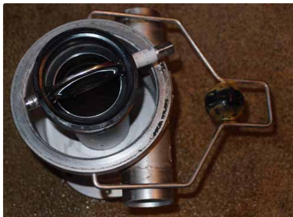
Figur 1. Udløbsventil på mælkekøletanke.
