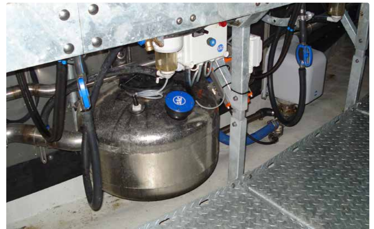
Figur 6. Mælkeudskiller på stor malkekarrusel udført i rustfrit stål.
