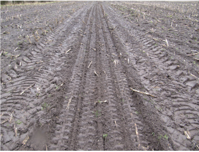
BILLEDE 6: Spor med RollMax sænket til venstre og spor med RollMax hævet til højre
