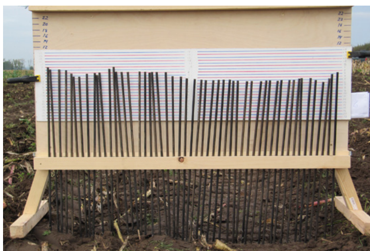
BILLEDE 9: Måletavle, der viser spordybden med RollMax sænket. Nedsynkningen er her ned til ca. 6 cm, hvor det er størst.
