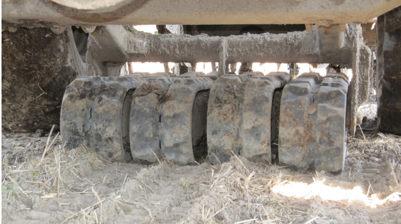
BILLEDE 7: Bælteundervognen nedsænket i en harvet stubmark efter en kornafgrøde.
