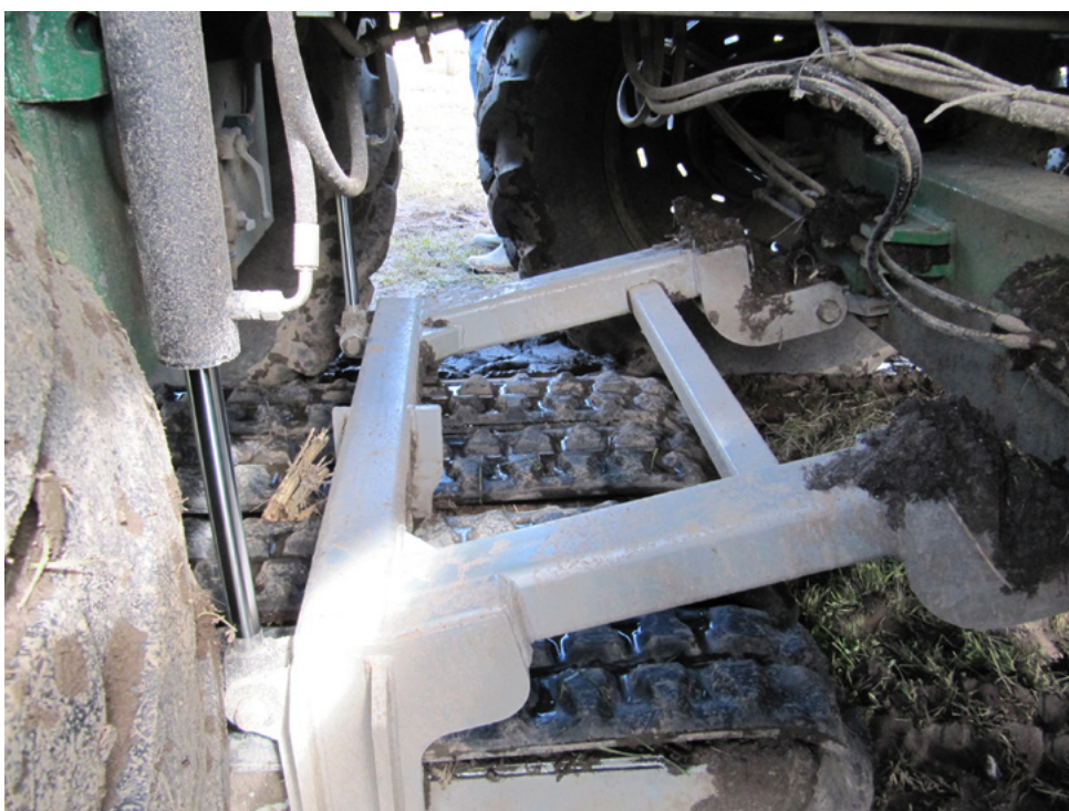
BILLEDE 1: RollMax bælteundervogn med fire bælter monteret på treakslet Samson PG 25 gyllevogn.
