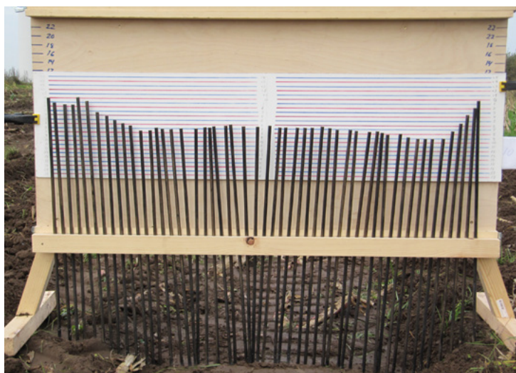
BILLEDE 8: Måletavle, der viser spordybden, når RollMax er hævet. Nedsynkningen er ned til ca. 9 cm.
