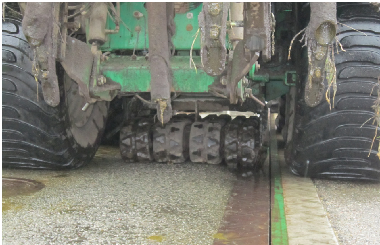
BILLEDE 5: Køretøjet vejes på brovægt for at kende vægtfordelingen, og dermed hvor meget RollMax bælteundervognen kan afløstet gyllevognens trippelaksel.
