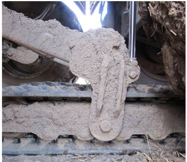
BILLEDE 2: Bælteundervognen består af fire bælter, hver med en bredde på 23 cm og en højde på 32 cm. To hydrauliske stempler presser konstruktionen ned mod jorden, og overfører dermed op imod 10 ton af belastningen på gyllevognens trippelaksel til bælteundervognen.
