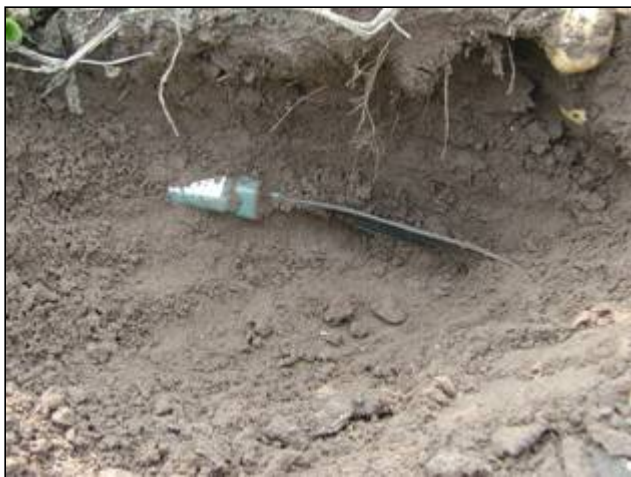
Figur 1. Ovenfor ses sensoren nedgravet i jorden. Til højre ses databoks med solcelle.
