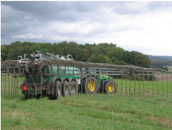
Figur 9.1 Flyvende start: Gyllepumpen og sektionfordeleren aktiveres, mens der køres op i næste kørespor.
