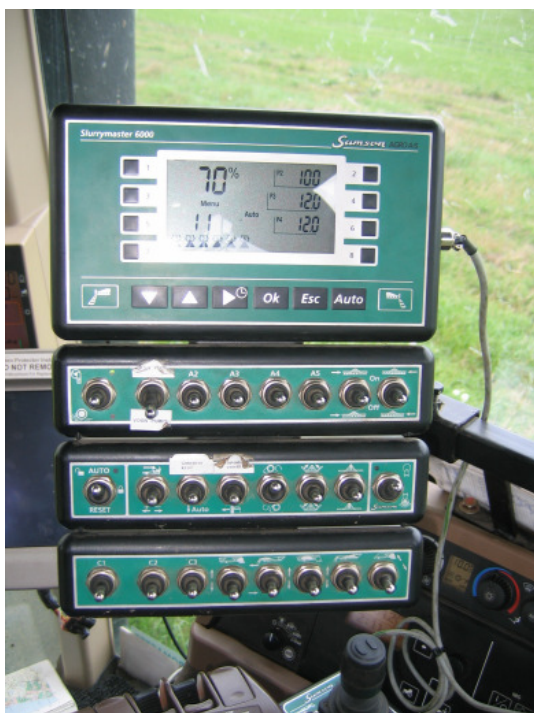
Figur 5.9 Styrepult til gyllevogn og sektionsfordeler. Den manuelle styring sker ved at vippe en kontakt på styrepulten inde i traktoren. Hvert vip med kontakten lukker/åbner for en sektion på én eller flere meterstykker af gangen – alt efter ønske.
